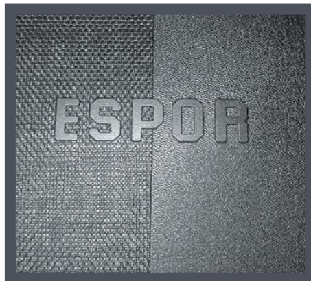
Термоформована структурна част, Полистирол 1мм, произведена от порьозна матрица от ESPOR®
